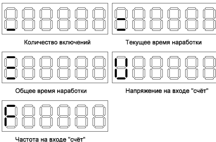
Рисунок 3 – Режимы индикации счётчика моточасов WTM-32
