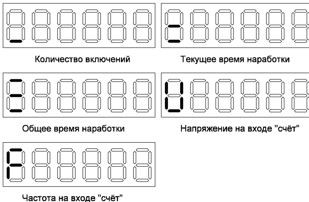
Рисунок 3 – Режимы индикации моточасов WTM-01
