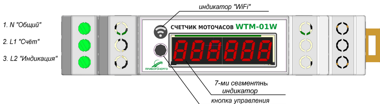
Рисунок 2 – Панель управления и индикации и назначение выводов счётчика моточасов WTM-01W
