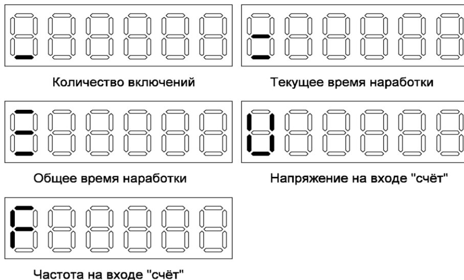
Рисунок 3 – Режимы индикации моточасов WTM-01W
